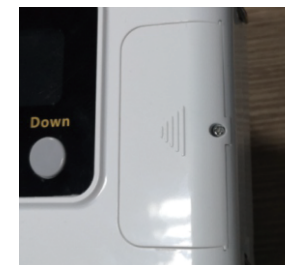
Крок 10: закрийте кришку відсіку акумулятора та закрутіть гвинти
