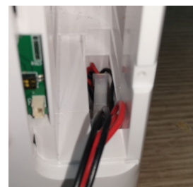
Крок 7: спочатку роз'єм уставляється в паз у нижній частині відсіку акумулятора
