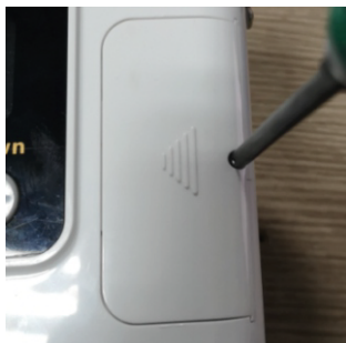
Крок 1: викрутіть гвинти на кришці відсіку акумулятора за допомогою хрестоподібної викрутки
