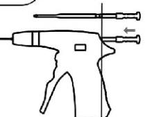
**! ОБЕРЕЖНО:** введення плангера в обтураційний пістолет не повністю може спричинити несправну роботу спускового гачка.
